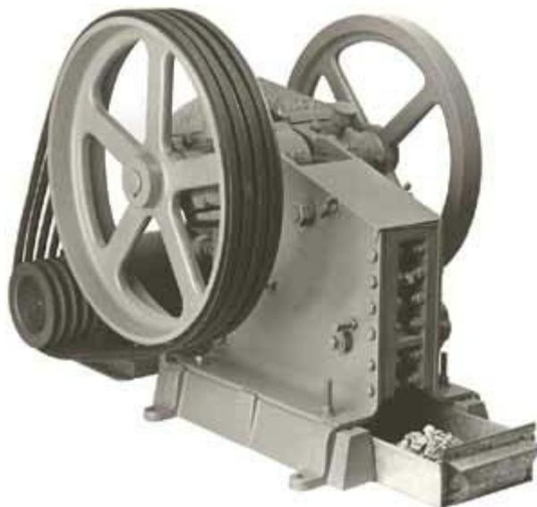
Модели GLC-33 и GLC-34 имеют размер щеки 3x6"(76x152mm) с щелью размером 3x2.25"(76x57mm). Установочный маховик регулирует размер щели между щеками для изменения размеров результирующих частиц от 1/16" до 3/8"(1.6-9.5mm). Модели GLC-35 и GLC-36 имеют размер щеки 4x9"(102x229mm) с размером загрузочной щели 4x2 3/8"(102x60mm). Размер измельчения варьируется от 1/16"(1.6) до 5/8" (15.9mm).
