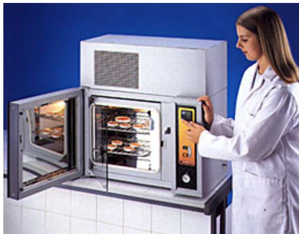
резистивного датчика. Максимальная температурная однородность достигается за счет циркуляции воздуха в камере высокоэффективным вентилятором. Тепловая изоляция камеры обеспечивается использованием высококачественной керамико-волоконной оболочки и гарантирует безопасную температуру внешних поверхностей корпуса. Пониженная температура в инкубаторе обеспечивается герметичной охлаждающей системой
