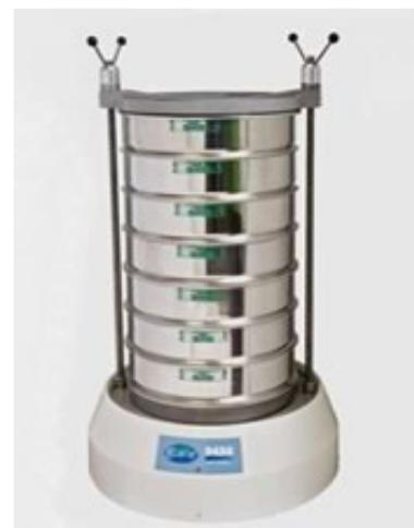
D450 это мощный ситовой анализатор, разработанный для того, чтобы вмещать до 7 сит диаметром 250/300/400 и 450мм + приемный поддон. Шейкеры D450 оснащены уникальной системой фиксации. Она обеспечивает надежное закрепление стека сит без чрезмерного затягивания винтов и позволяет быстро снимать и заменять сита.
