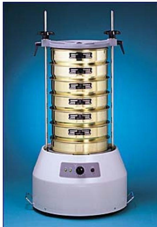
Уникальная система зажима обеспечивает постоянное усилие прижима без чрезмерной затяжки и вместе с тем позволяет быстро заменить сита.
